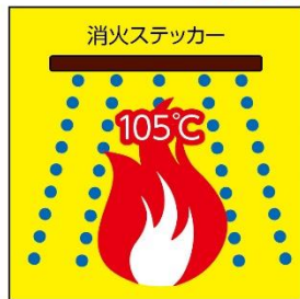
105°Cの熱を感知するとステッカーのマイクロカプセルが弾け、カプセルに充填されている消火剤が自動的に散布される
